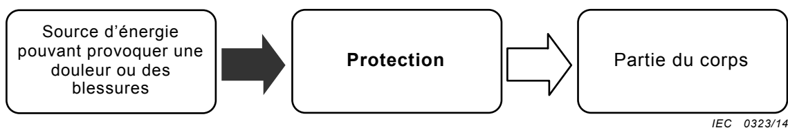
Figure 2 – Modèle en trois blocs pour la sécurité
